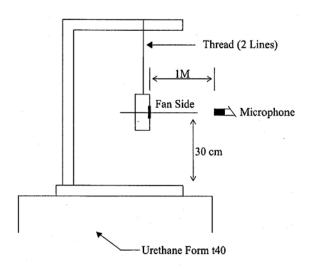
1 METER FROM MICROPHONE TO FAN INTAKE
